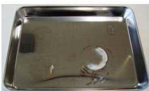
コップを置いたり、吸盤をはりつけたりしたバットでは、腐食しているのはコップの下や吸盤の下だけです。
