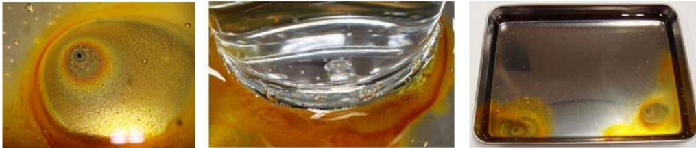
3) 実験後の観察：早ければ1日以内でバットに孔があいて食塩水が漏れます。実験を中止して食塩水を捨て、さびを拭き取ってどのように腐食しているか観察してみましょう。
