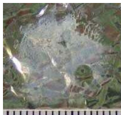
写真3.3.6 銀製ペンダントが置かれていた周辺でアルミニウム箔がさびた状況
