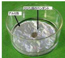
写真3.3.3 さびた銀製ペンダントの電池反応によるクリーニングの状況
