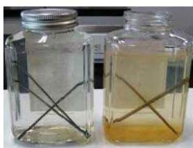
1 日経過後の腐食状態
