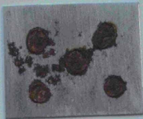
そのままの鉄板に食塩水を付けて放置
